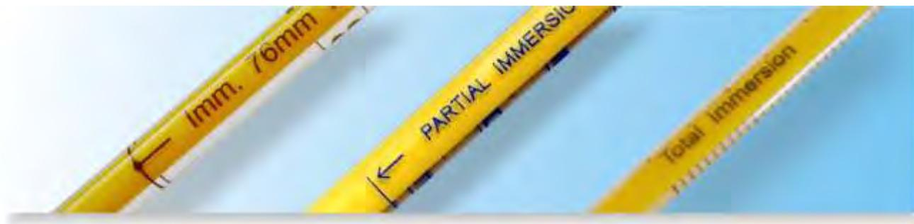
**Si un termómetro no se utiliza con la inmersión para la que fue calibrado, es necesario hacer una corrección:**
