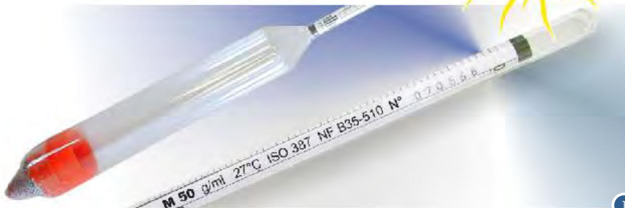
La temperatura normal de referencia para densímetros en densidad es de 20 °C. En circunstancias especiales y en los países tropicales, es necesario trabajar a una temperatura ambiente superior. La norma ISO 387 permite el uso a 27 °C para los instrumentos normalizados y hasta 27,5 °C para los no normalizados.
