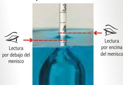
**La lectura se hace en el punto de encuentro entre la superficie del líquido y la escala del instrumento, por arriba o por debajo del menisco, según el líquido utilizado**
