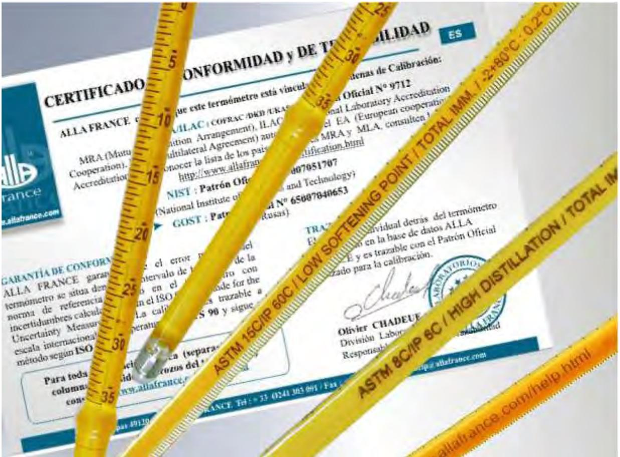
Muchos termómetros **IP** corresponden con los termómetros de norma americana **A.S.T.M.**
